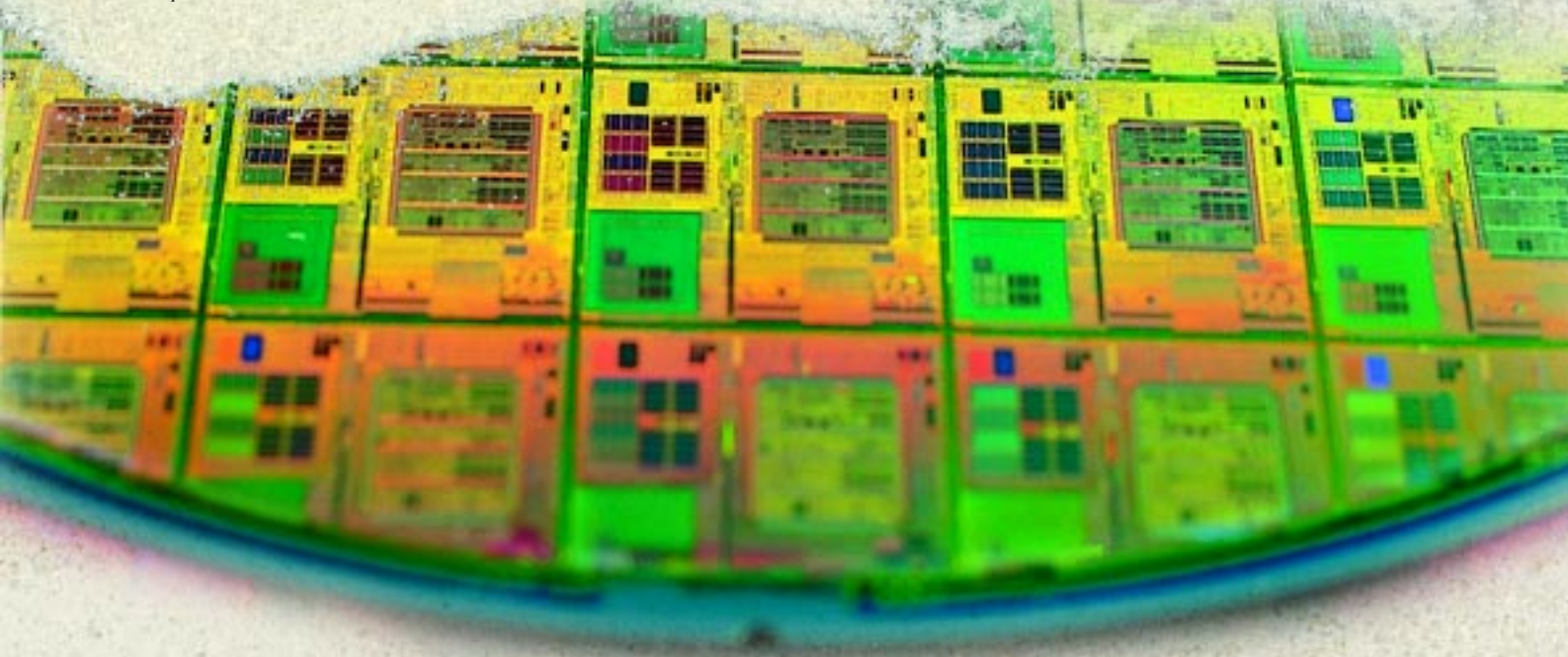
Siliziumwafer mit Computerchips (quadratische Areale). Moderne Chips enthalten über 100 Millionen Einzeltransistoren.
